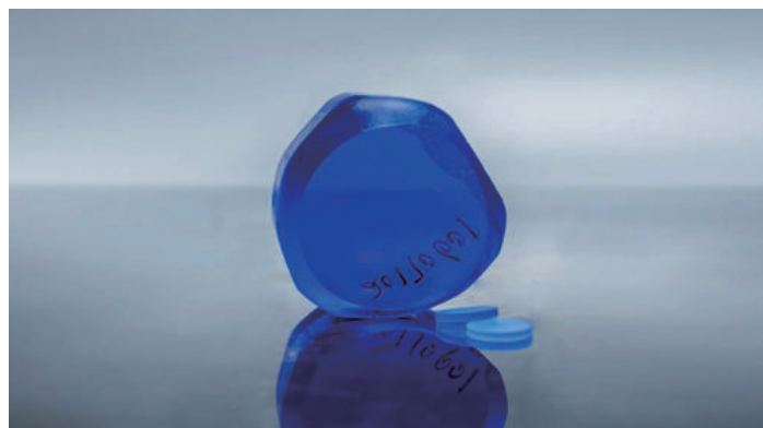
图2. 常见饱和吸收体 Co:Spinel晶体
